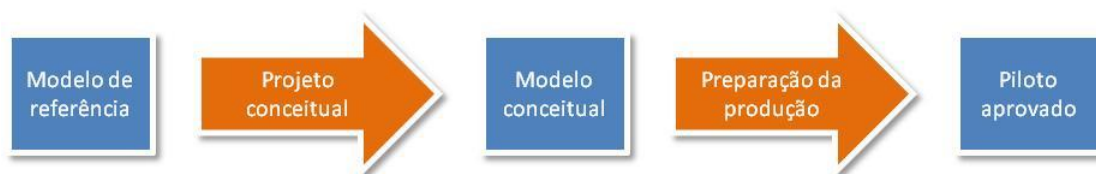
Figura 14 – Transformação do modelo durante o processo de Desenvolvimento de Produtos (Elaborado pelo autor)
