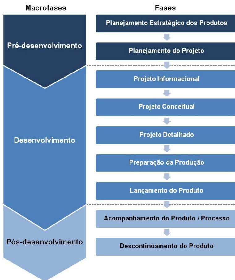
Figura 6 – Fases do processo de Desenvolvimento de Produtos (ROZENFELD et al., 2006)
